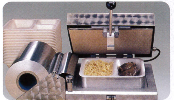
Tissu de verre imprégné de PTFE aux dimensions souhaitées pour machines de scellage.
