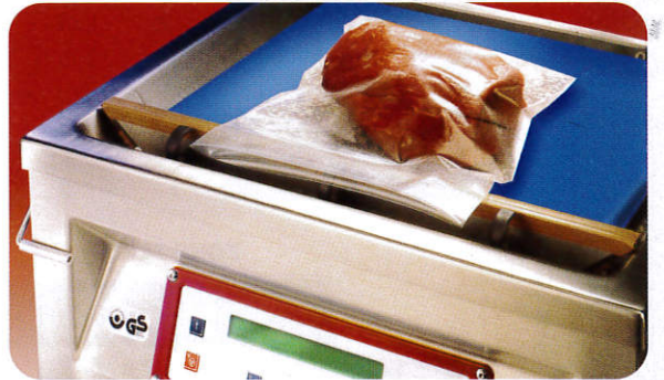
Les rouleaux de tissus adhésifs imprégnés de PTFE ont d'excellentes propriétés d'anti-adhérence dans le domaine des machines d'emballage.
